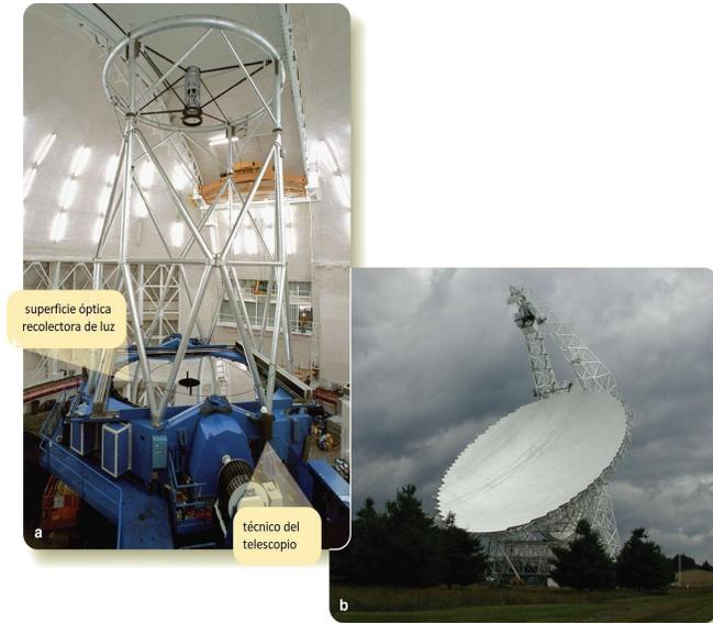
**Figura 2:** (a) Telescopio de 8 metros de infrarrojo cercano y visual Gemini Norte. (b) Radiotelescopio de 100 metros Green Bank, en Virginia Occidental. (De *Foundations, Seeds & Backman*, © 2016 Cengage Learning).
